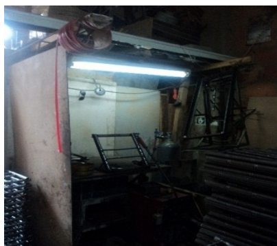
FOTOGRAFÍA 3. CABINA DE SOLDADURA
